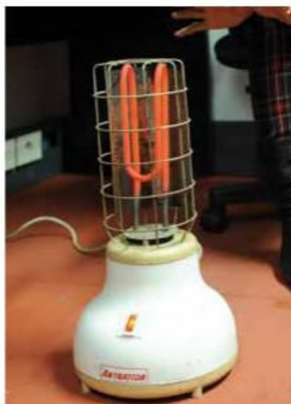
Las estufas eléctricas con resistencias metálicas que emiten luz al calentarse debido a la circulación de corriente eléctrica.
