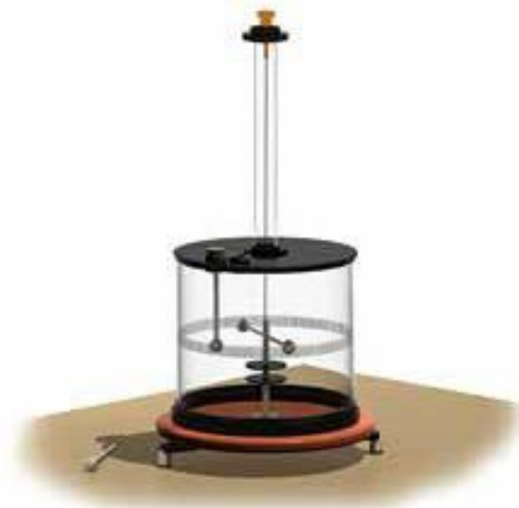
Balanza de Coulomb. Al interactuar las bolitas metálicas cargadas, la barra suspendida de un alambre gira un ángulo que se puede medir en el cilindro exterior. Eso permite calcular la fuerza eléctrica entre dos de las esferas cargadas
