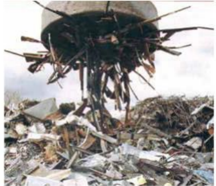
Las grúas magnéticas pueden levantar cuerpos muy pesados que contengan algún material ferromagnético.
