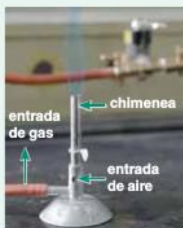
Mechero de Bunsen funcionando con la entrada de aire abierta.
