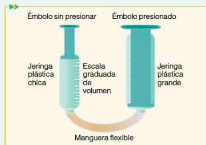
Esquema del dispositivo armado con las jeringas.
