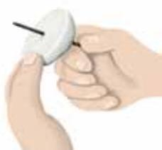
**3** Corta un trozo del palillo, entre 1.2 y 1.4 cm, que incluya una de sus puntas. Introduce el trozo del palillo en el agujero de la tapa, hasta el ras de la cara exterior de la misma, cuidando que el palillo quede vertical. Cubre la cara exterior de la tapa con un trozo de tela adhesiva, para evitar fugas de agua. Con esto habrás terminado el contenedor de agua de tu brújula, incluyendo su pivote de rotación.
