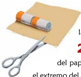
**1** Corta una tira del cartoncillo y haz un cilindro para que puedas mantener juntas las dos pilas, una atrás de la otra (en serie).
