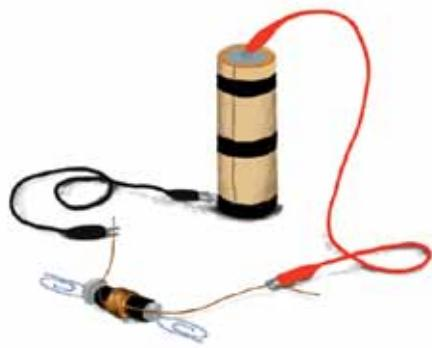
Con lo anterior, tu electroimán está listo para funcionar. Para probarlo conecta una de sus terminales al polo negativo de la batería y deja su otra terminal lista para conectar al polo positivo. Acerca un clip al electroimán antes de conectar y verás que no pasa nada; luego termina la conexión a la batería y notarás que el clip es atraído por el electroimán e inclusive puedes levantar el
