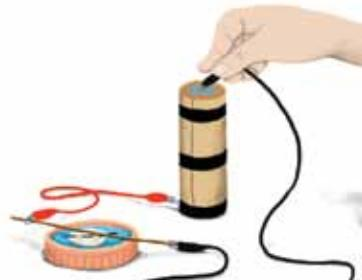
**4** Prueba colocando el alambre de manera perpendicular a la aguja de la brújula. Si lo hiciste bien no girará aunque inviertas la polaridad de la batería.
