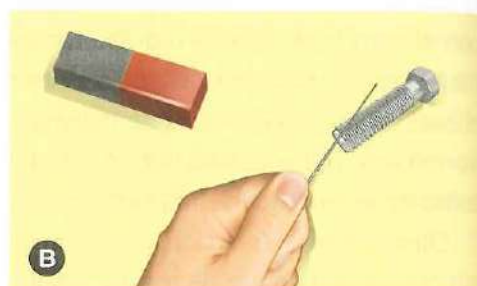
B. La aguja se magnetiza y se comporta como un imán.
