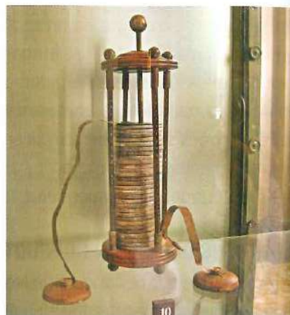
Réplica del aparato desarrollado por Volta.
