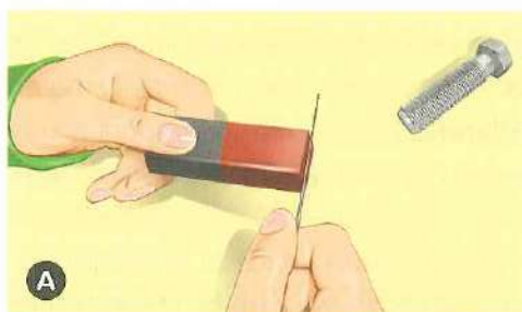
A. Se frota la aguja con un imán empezando siempre por el mismo extremo, reiteradas veces.
