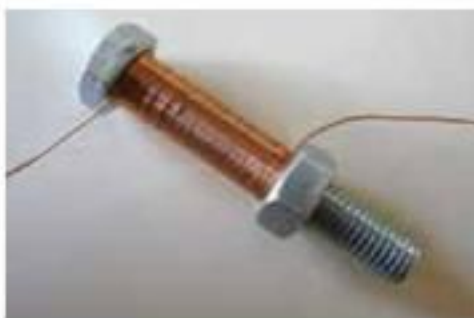
Electroimán elemental construido con un tornillo y un cable enrollado.
