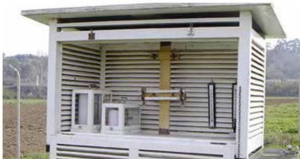
Los termómetros se encuentran dentro de una casilla o abrigo meteorológico.
