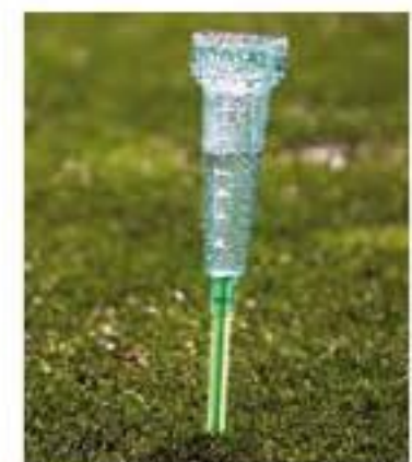
El pluviómetro es un recipiente cilíndrico que recolecta el agua de lluvia.
