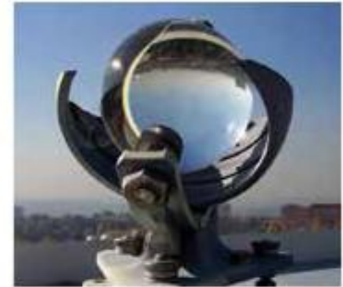
Heliofanógrafo. La lente es atravesada por la radiación solar, que quema la faja de papel que está abajo.
