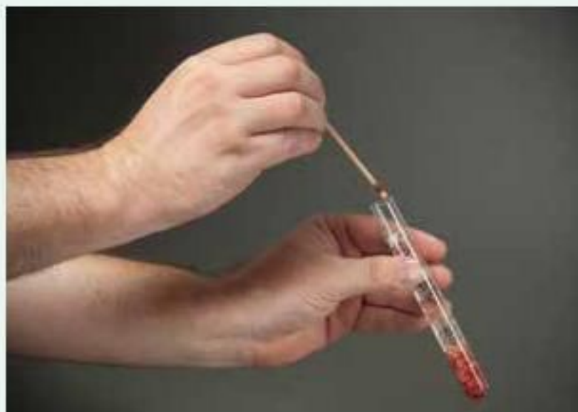
Astilla con punta incandescente para reconocer el oxígeno desprendido en la reacción química.
