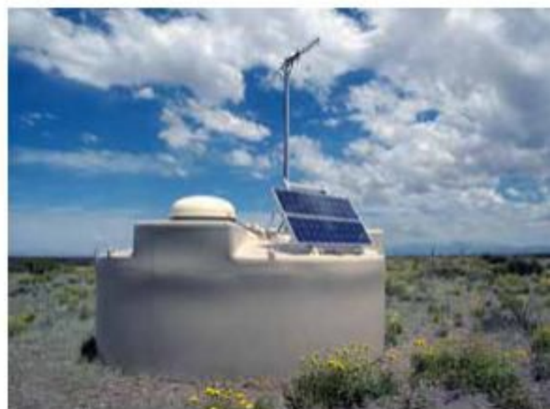
Uno de los 1.600 detectores cilíndricos de radiación cósmica.
