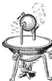
► Esquema de la eolípila. Fue creada por Herón de Alejandría en el siglo I d. C. Se llenaba de agua que se calentaba con una mecha. El vapor, al salir por los conductos, hacía girar la bola de metal.
