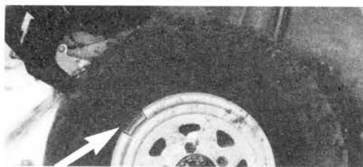
Masas de balanceo. Sin ellas, la rueda vibraría cuando el vehículo marcha a gran velocidad.
