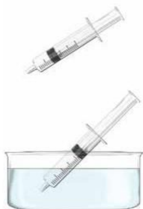
Cuando el agua calienta el aire dentro de la jeringa, éste se dilata y empuja el émbolo hacia afuera.
