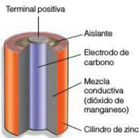
Corte transversal de una pila común.
