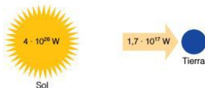
Esquema de la emisión y recepción de potencia entre el Sol y la Tierra.
