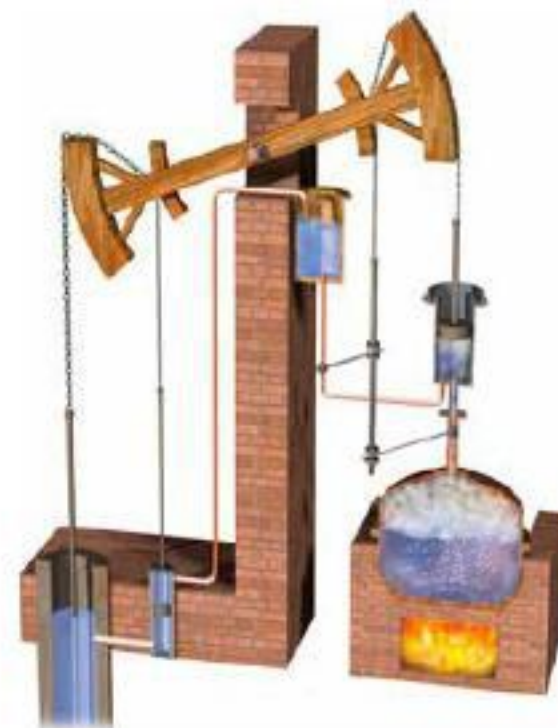
Máquina de Newcomen. Aun con su bajo rendimiento, se utilizó entre 1712 y 1770, aproximadamente.
