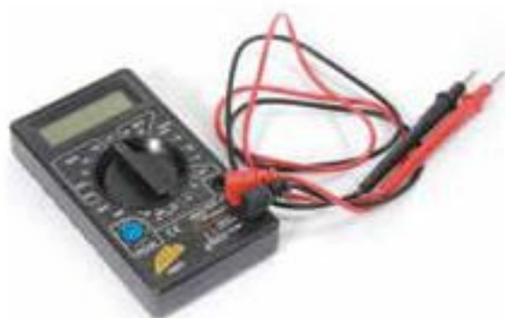
Multímetro digital. Al girar su selector central, puede funcionar como amperímetro, voltímetro u óhmetro en diversas escalas.
