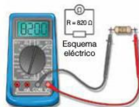
Los multímetros o tester que se venden habitualmente en los comercios especializados tienen escalas especiales para actuar como óhmetros y llevan una pila o batería para realizar esa función.
