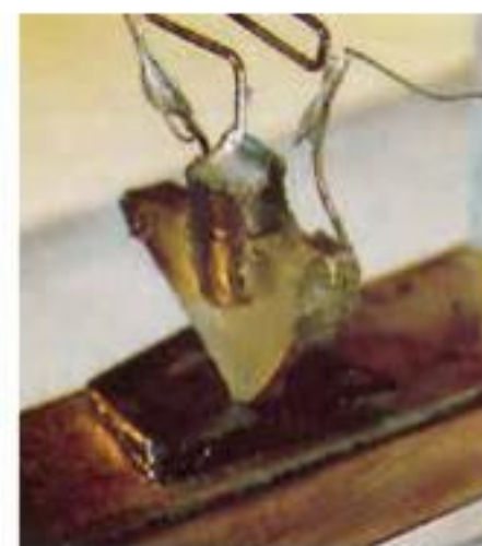
Primer transistor fabricado por J. Bardeen, W. Brattain y W. Shockley.
