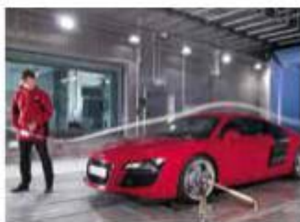
El túnel de viento permite visualizar y medir el efecto del aire sobre la carrocería en movimiento.
