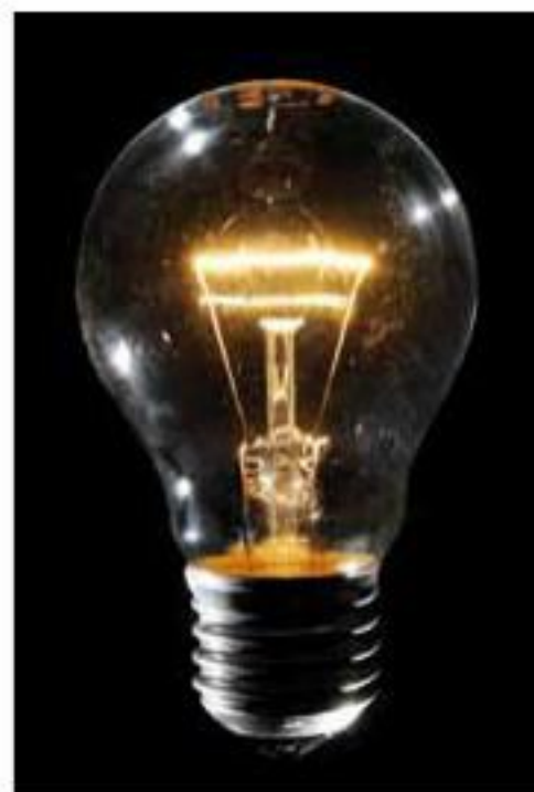
El filamento de una lámpara emite radiación infrarroja, además de luz visible.
