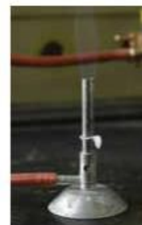
La creación del mechero de Bunsen, hoy presente en cualquier laboratorio, fue el resultado de los ensayos realizados por este químico para lograr una llama pura y sin luminosidad, indispensable para el análisis espectral.
