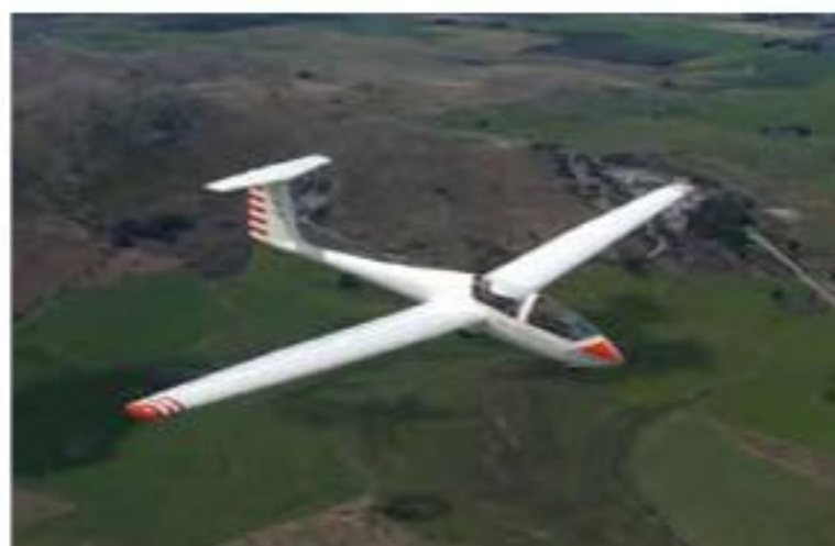
Los planeadores y los ala delta no utilizan motores, usan las corrientes convectivas del aire.
