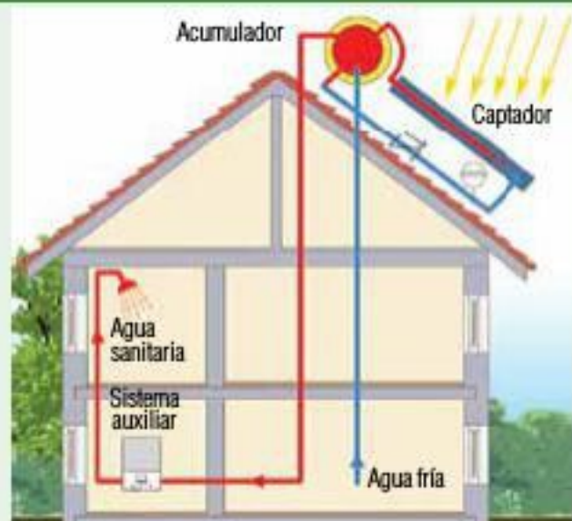
Esquema del funcionamiento de un calefón solar.
