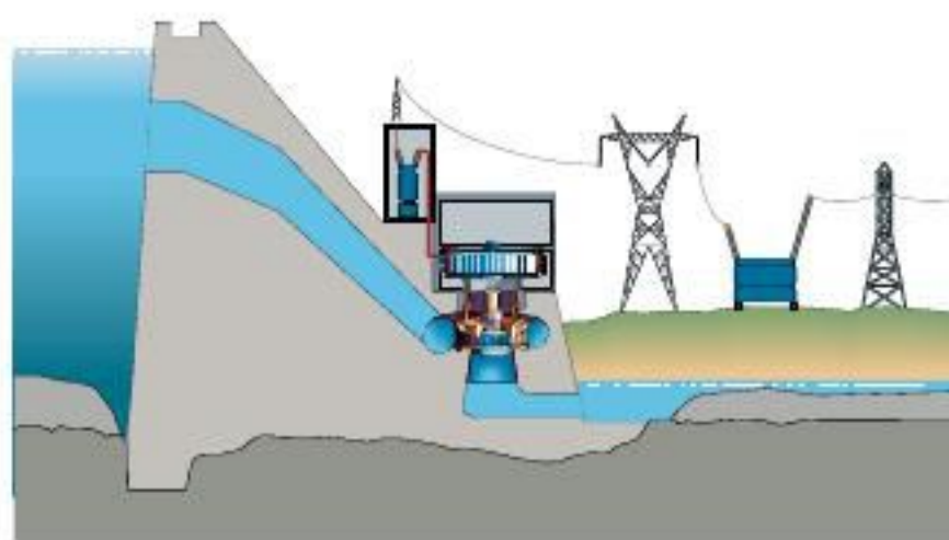
Centrales hidroeléctricas de desvío e intercepción.
