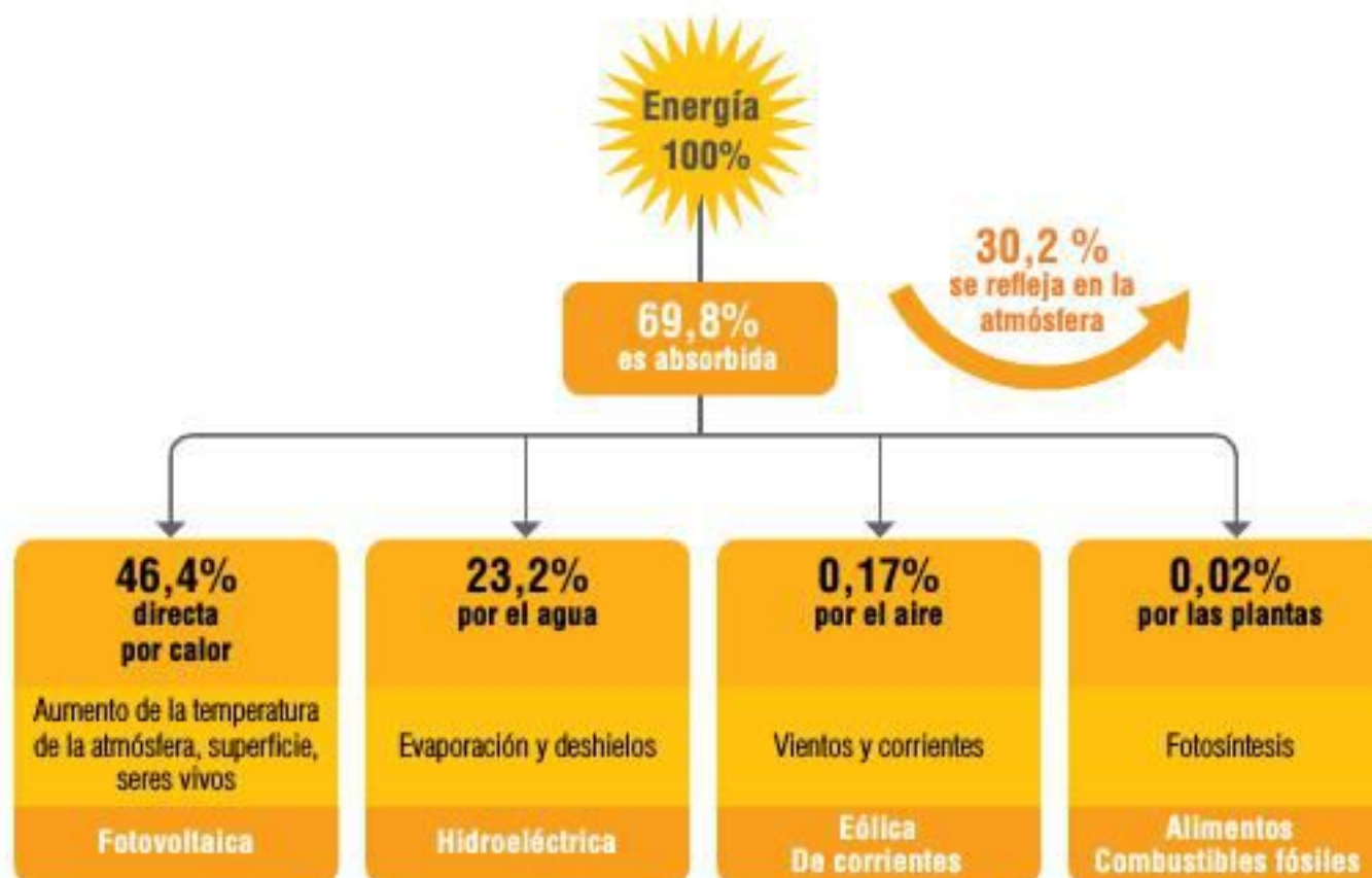
Esquema de la energía que llega del Sol y los porcentajes absorbidos por cada elemento.
