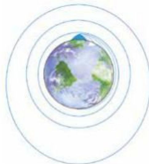
Al lanzar un cuerpo con suficiente velocidad, entrará en órbita alrededor de la Tierra debido a su caída permanente.
