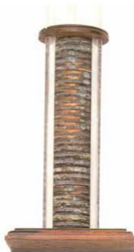
En el año 1800, Alessandro Volta creó la primera fuente electroquímica. Se la llamó pila porque, para fabricarla, apiló treinta discos de zinc y cobre, alternadamente, separándolos con paños embebidos en ácido sulfúrico.
