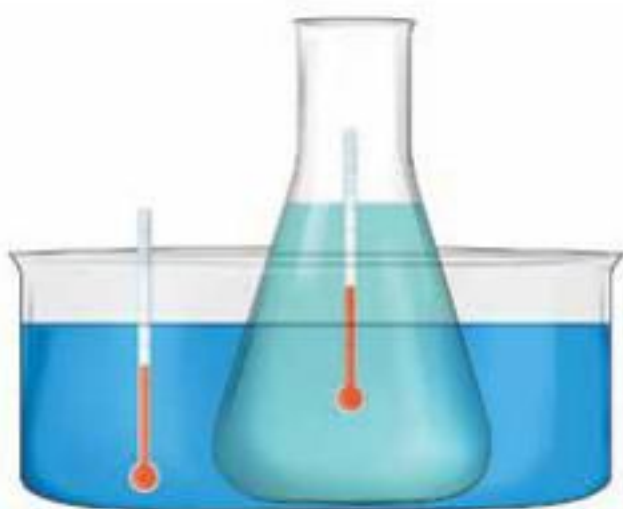
Si se coloca un recipiente con agua caliente dentro de otro con agua fría, aislados del exterior, después de un tiempo, sus temperaturas se igualarán.
