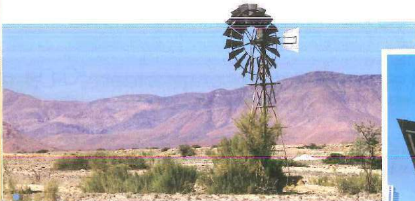
▲ Molino de viento utilizado tradicionalmente en las zonas rurales de nuestro país para extraer agua
