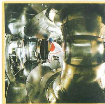
El ITER es un reactor con el que se intenta conseguir la fusión controlada de isótopos de hidrógeno para producir helio y una gran cantidad de energía.
