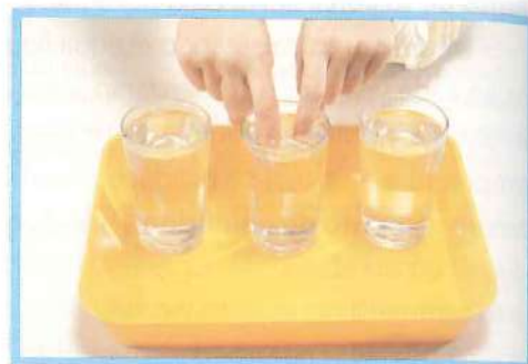
Experimento para comprobar la poca fiabilidad de los sentidos al medir la temperatura de una sustancia.
