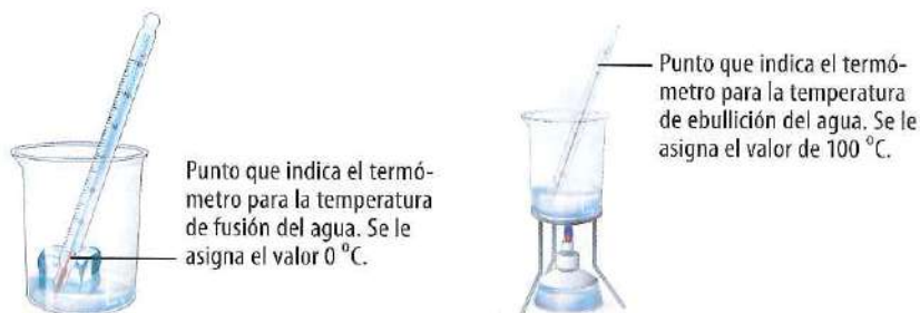
Establecimiento de los puntos fijos inferior y superior de la escala de Celsius, como el punto de fusión y de ebullición del agua, respectivamente.
