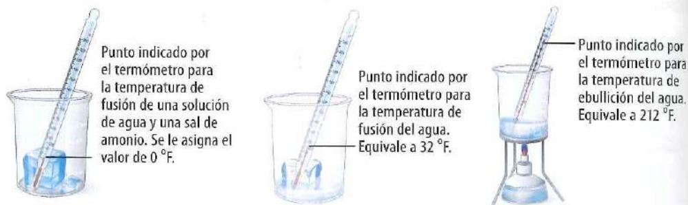
Establecimiento del punto fijo inferior de la escala Fahrenheit, y medición del punto de fusión y de ebullición del agua en esta escala.
