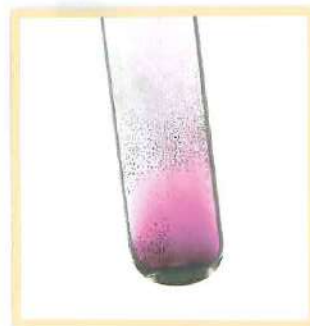
La sublimación inversa del yodo se produce cuando el vapor de yodo entra en contacto con una superficie fría.
