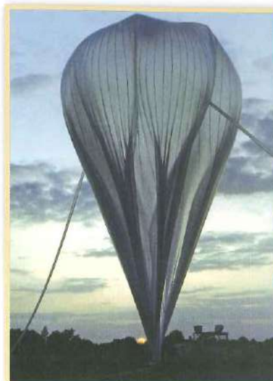
Globo de exploración científica de gran altura, hecho de polietileno superfino y resistente. Estos globos están llenos de helio inerte y pueden mantenerse en el aire hasta 24 horas y a 50 km sobre el nivel del mar.
