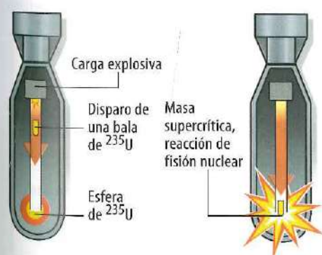
Esquema de la bomba de uranio arrojada por Estados Unidos sobre Hiroshima.
