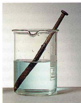
Fig. 10-9. El clavo de hierro dentro de la solución azul se recubre de una capa de cobre.
