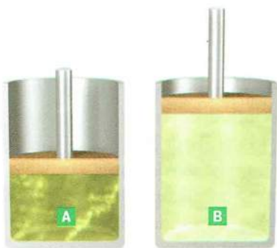
Fig. 9-2. Ambos sistemas contienen igual cantidad de gas cloro, pero el (A) es más concentrado que el (B), ya que el gas se distribuye en menor volumen.
