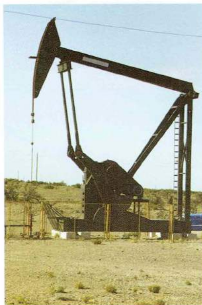
Fig. 1-1. Bomba de extracción vertical de petróleo. Consiste en un tubo vertical dentro del cual se mueve un pistón cuyo extremo superior está unido a las varillas de bombeo en el exterior. El 80% de los pozos de extracción en la República Argentina utilizan este medio.
